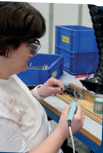
Löten ist einer von vielen Arbeitsschritten bei dem neuen Auftrag im Bereich der Kabelkonfektion.
